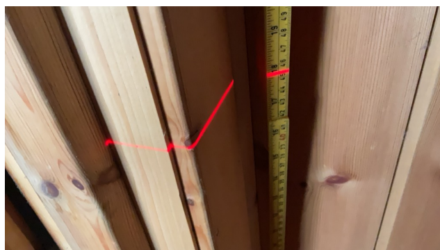
Målt høyde på 45,5 cm og avvik på 40 mm
