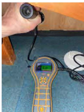
Bildet viser fuktmåling av rom under terreng.
