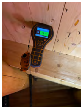
Ingen unormale verdier ved fuktsøk mot tretto.
