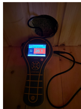
Fuktmålinger i treverk under gulvet
