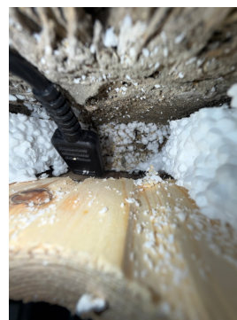
Fuktmålinger i treverk under gulvet
