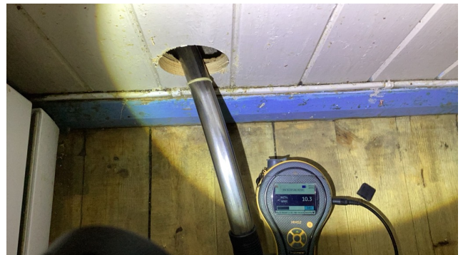
Viser fuktmåling uten å avdekke indikasjoner på fukt.
