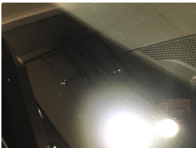
2.5 Steinsprut med sprekk
