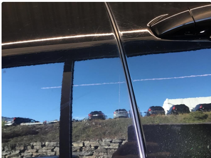
2.1 Diverse bruks merker/normal bruks slitasje
