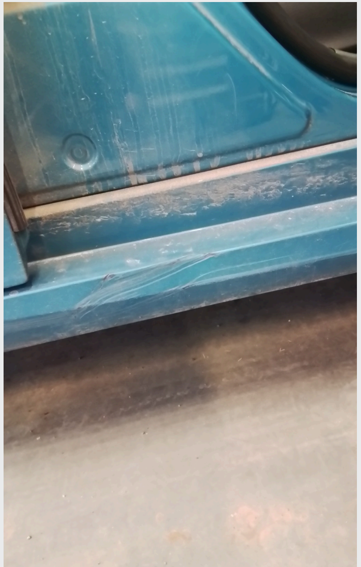
2.1 Flere større riper og bulker langs høyre side
