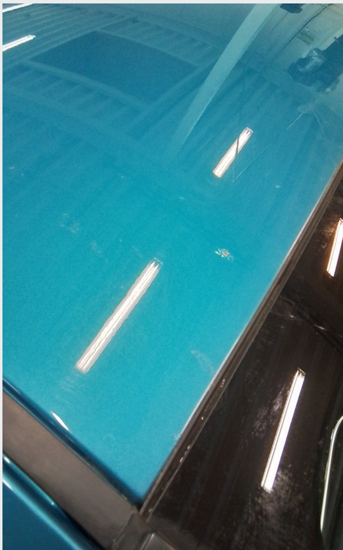
2.14 Rustbobler på tak
