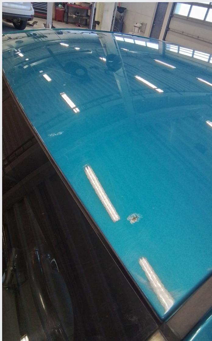
2.14 Rustbobler på tak
