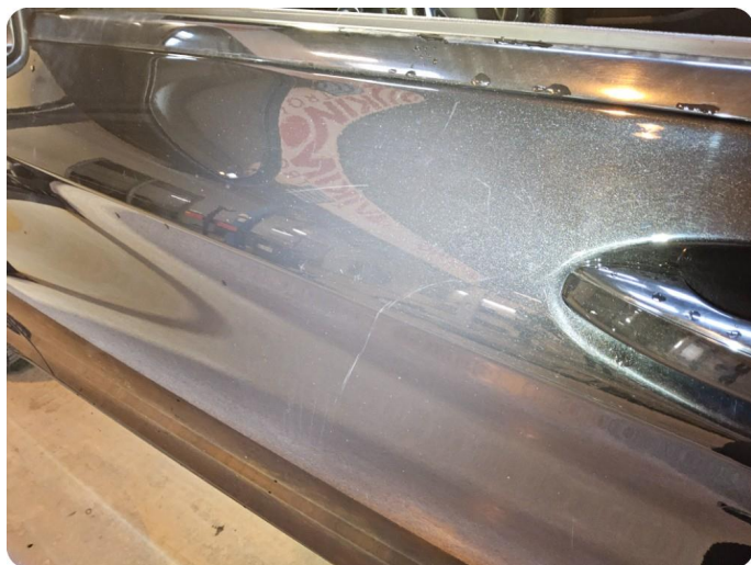
3.1 Generelt mye bruksslitasje / riper/ steinsprut.
