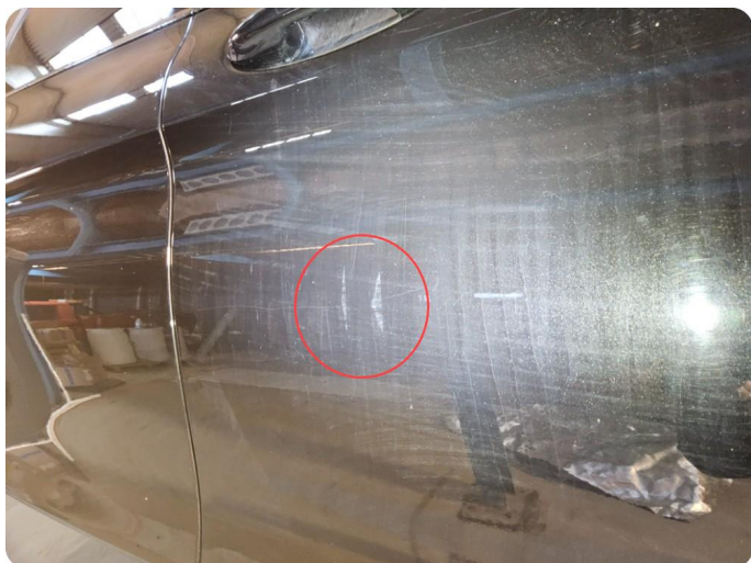
3.1 Generelt mye bruksslitasje / riper/ steinsprut.
