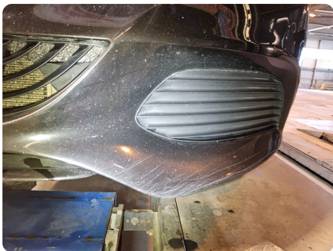
3.1 Generelt mye bruksslitasje / riper/ steinsprut.
