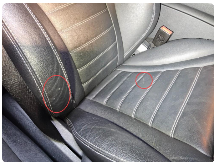
8.3 Øvrige feil Noe bruksslitasje / riper på interiør.
