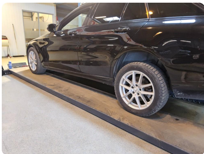
6.1 Feil på høyderegulering/skjev Setter seg i høyeste posisjon bak. Justerte seg til normal nivå etter parkering. Feilsøkes.
