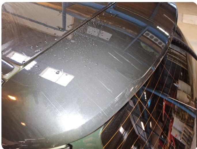
3.1 Generelt mye bruksslitasje / riper/ steinsprut.
