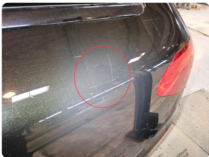
3.1 Generelt mye bruksslitasje / riper/ steinsprut.
