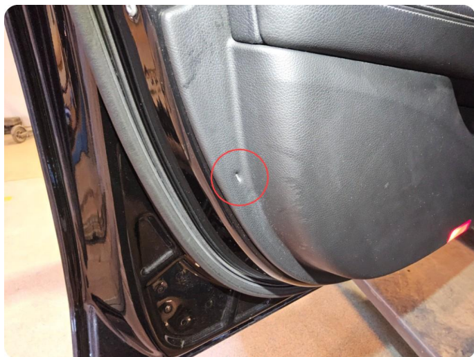
8.3 Øvrige feil Noe bruksslitasje / riper på interiør.
