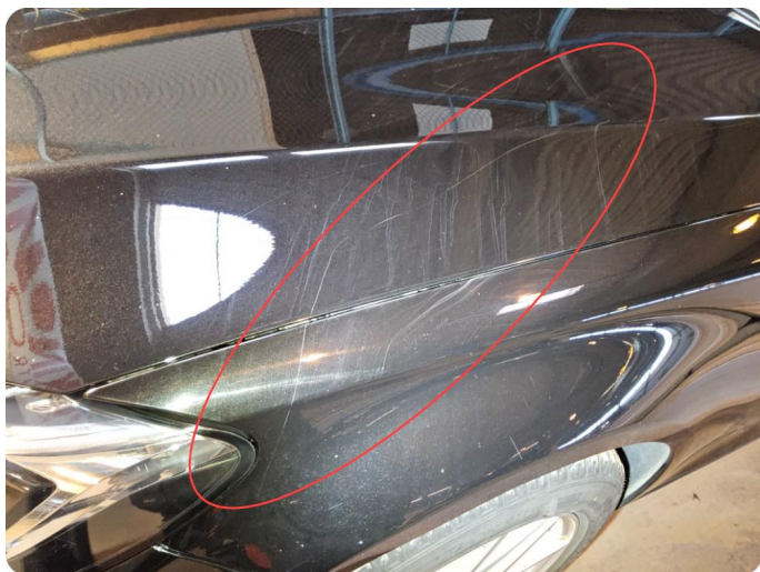
3.1 Generelt mye bruksslitasje / riper/ steinsprut.
