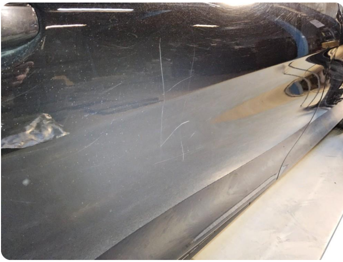
3.1 Generelt mye bruksslitasje / riper/ steinsprut.
