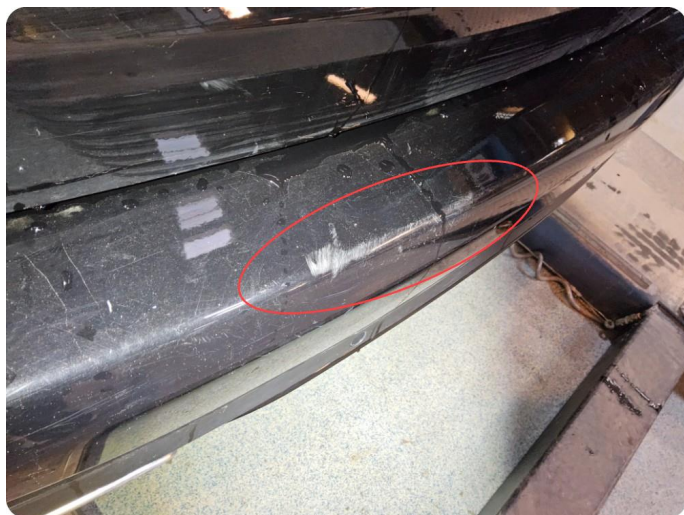
3.1 Generelt mye bruksslitasje / riper/ steinsprut.
