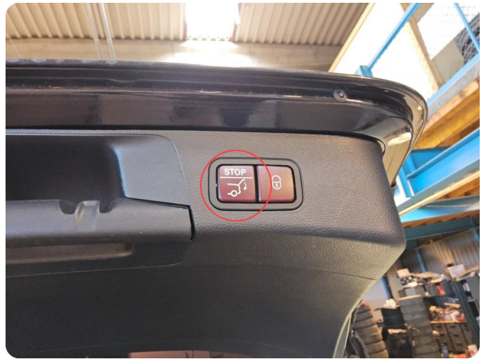
3.3 Feil på elektrisk åpne/lukkemekanisme Bryter virker ikke. Feilsøkes.
