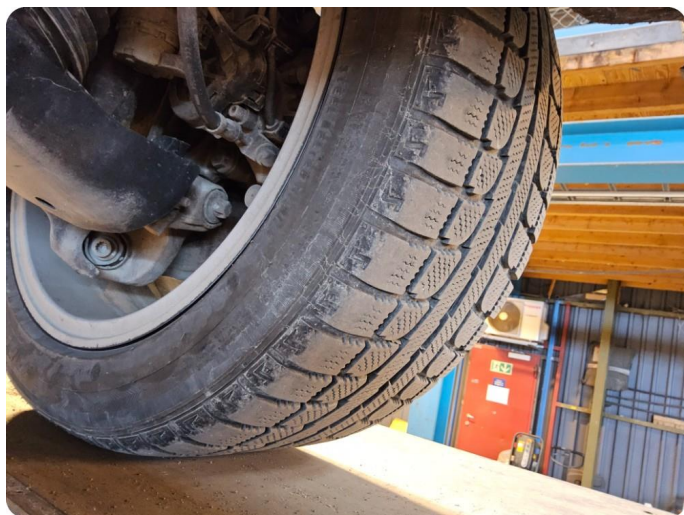
3.6 Skjev slitasje på vinterdekk Pris for to nye Nordman North RS3 i 225/50 17.
