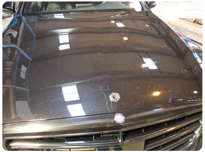
3.1 Generelt mye bruksslitasje / riper/ steinsprut.
