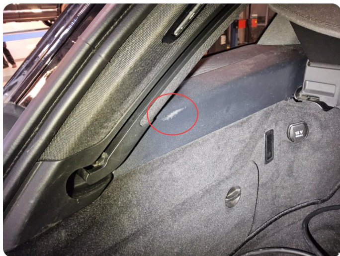
8.3 Øvrige feil Noe bruksslitasje / riper på interiør.
