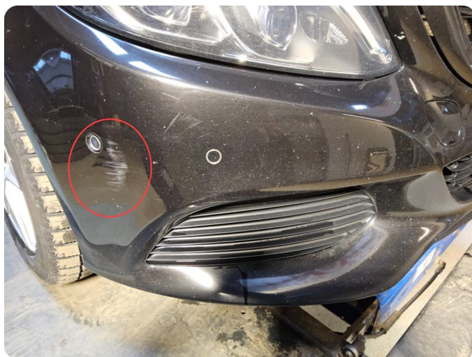
3.1 Generelt mye bruksslitasje / riper/ steinsprut.
