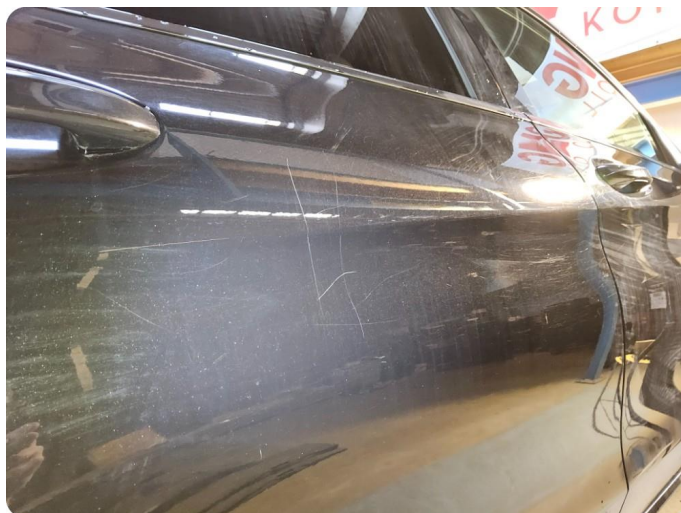
3.1 Generelt mye bruksslitasje / riper/ steinsprut.
