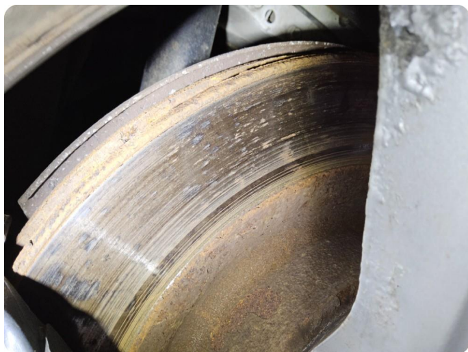
5.2 Rust Påbegynnende slitekant bak.
