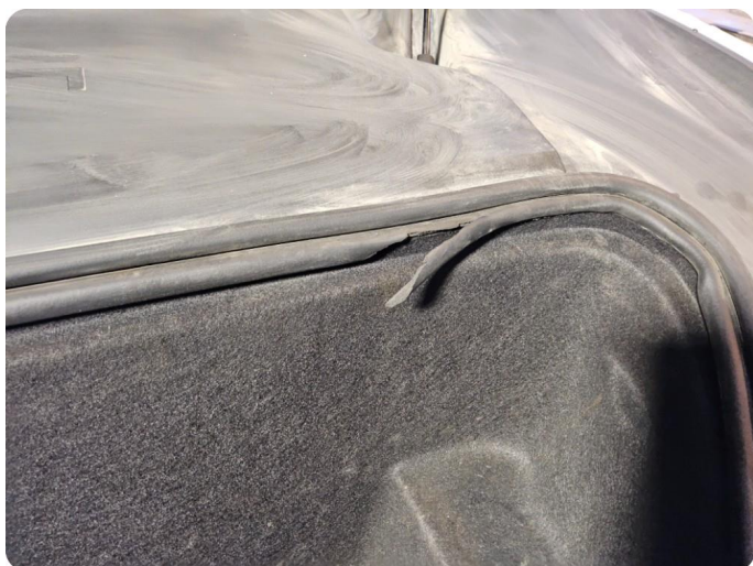
2.2 Øvrige feil Skadet pakning til oppbevaringsrom.
