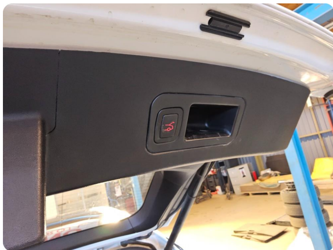
2.6 Feil på elektrisk åpne/lukkemekanisme Bryter virker ikke. Feilsøkes.
