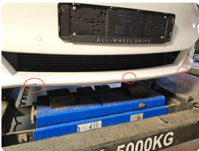
2.11 Skade / flere småsår.
