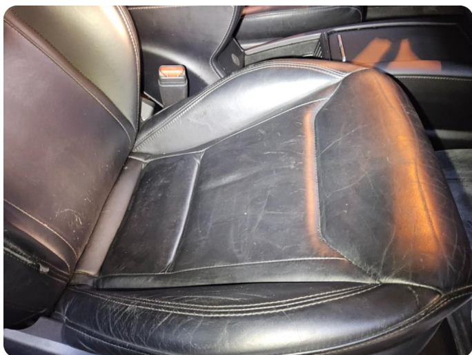
6.1 Øvrige feil Generelt mye bruksslitasje. Riper, småsår, misfarging, løse deksler.
