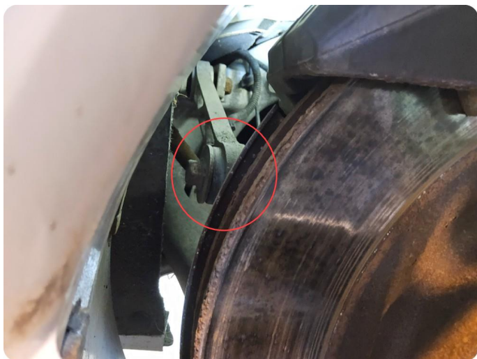
4.2 Utslitt bærebeforing Slakke. Ytre foring, fremre arm.
