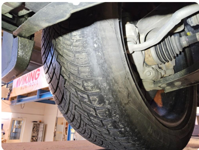
2.10 Skjev slitasje på vinterdekk / flere dekkskader. Pris for fire Nokian Hakka Black 3 i 245/45 R19. (Sommerdekk)
