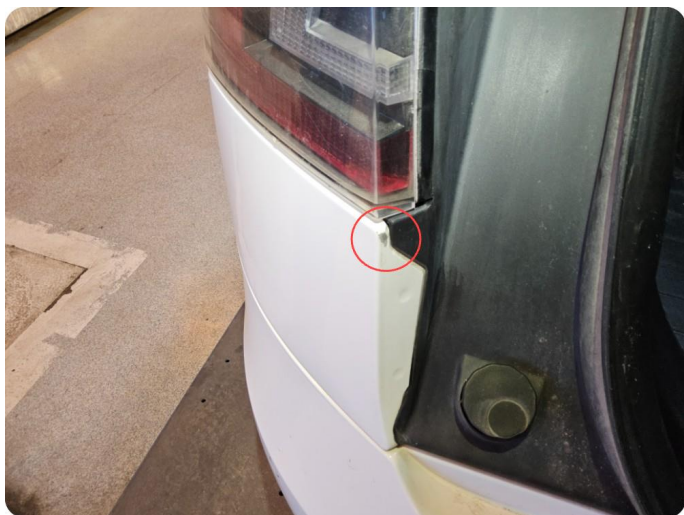
2.8 Øvrige feil Korrosjon.
