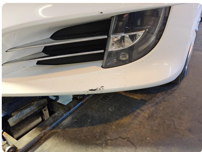
2.11 Skade / flere småsår.
