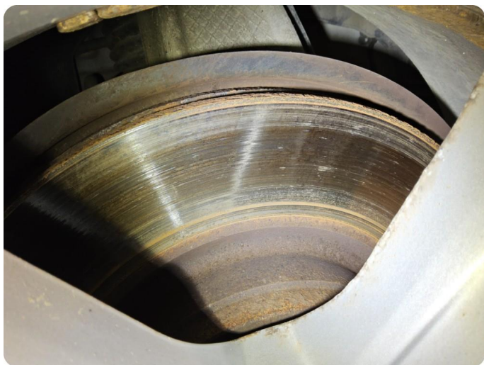
5.2 Rust Påbegynnende slitekant bak.
