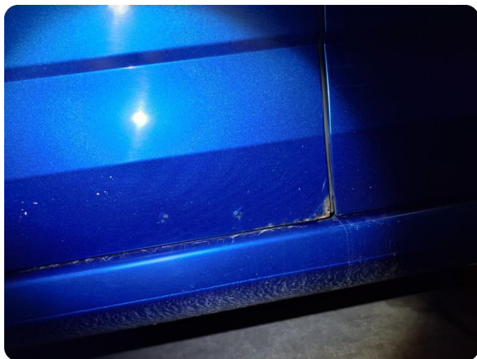
2.6 Generelt mye rust
