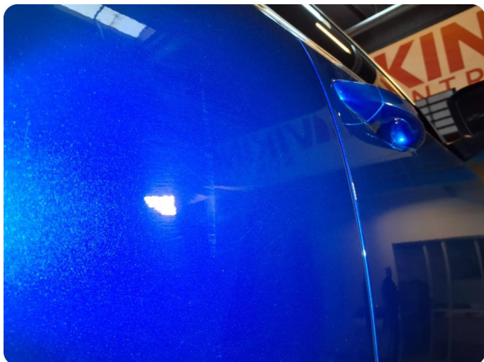
2.1 Generelt mye bruksslitasje Riper, steinsprut, oppskrapet
