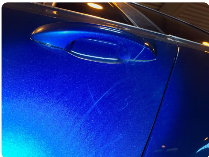
2.1 Generelt mye bruksslitasje Riper, steinsprut, oppskrapet
