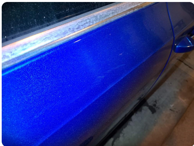
2.1 Generelt mye bruksslitasje Riper, steinsprut, oppskrapet
