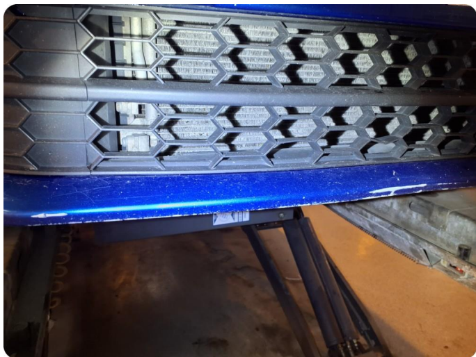
2.1 Generelt mye bruksslitasje Riper, steinsprut, oppskrapet
