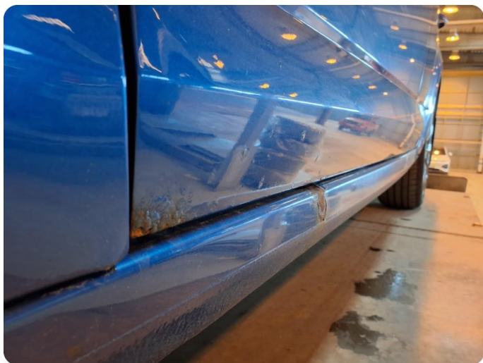
2.6 Generelt mye rust
