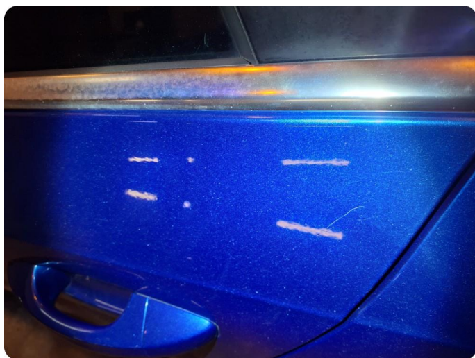
2.1 Generelt mye bruksslitasje Riper, steinsprut, oppskrapet
