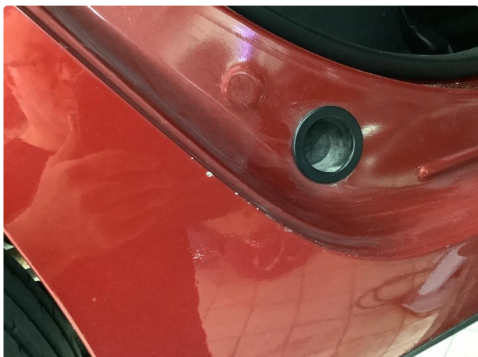
1.1 Ripe(r) ned til grunning
