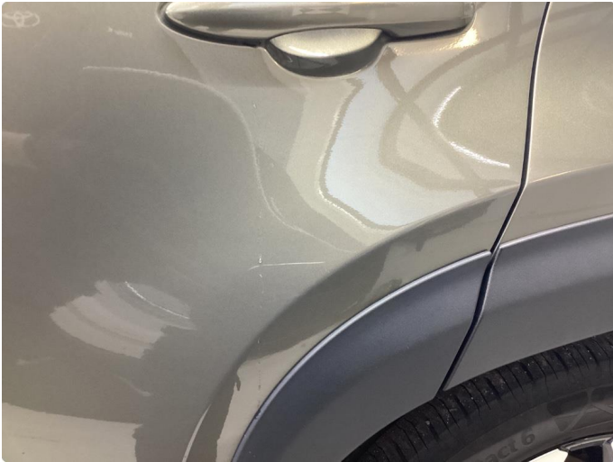
1.1 Ripe ned til grunning. NOE UTBEDRET PÅ KLARGJØRINGEN.
