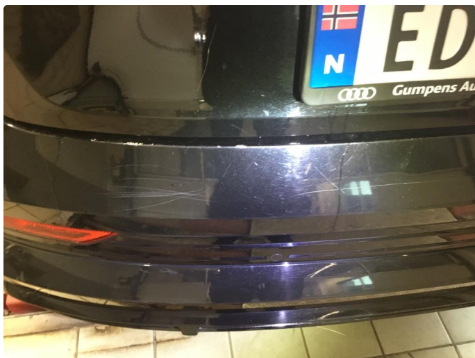
1.5 Bruksmerker. Normal slitasje.
