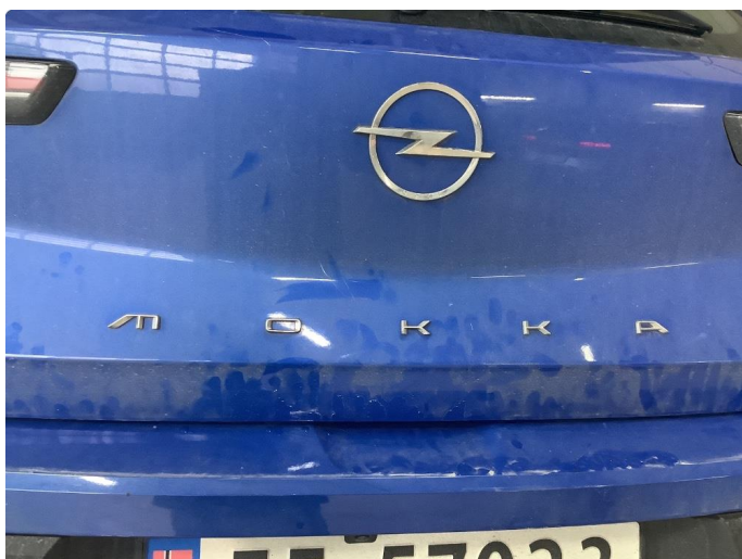
1.2 Ripe(r) ned til grunning
