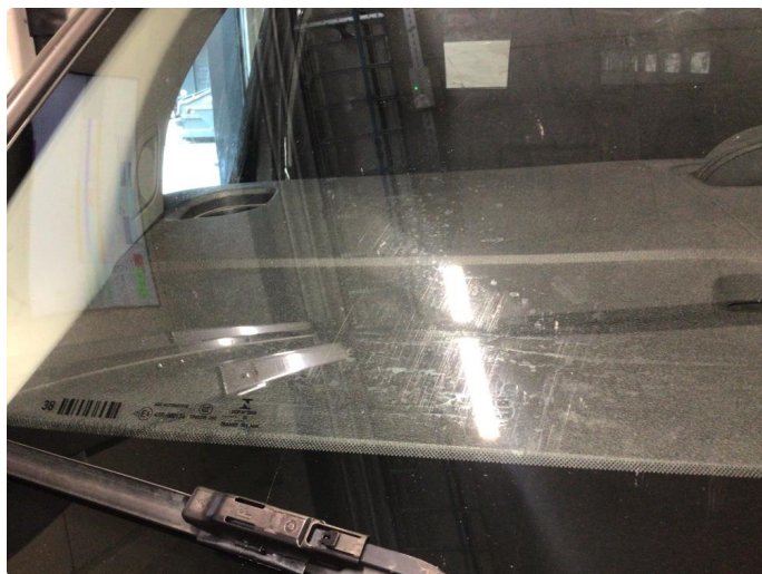
1.4 Noe slitasjeriper og steinsprut på frontvindu
