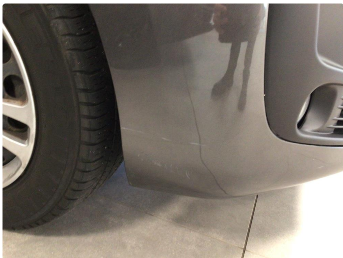
1.3 Noe riper på underside/nedre del av frontfanger begge sider
