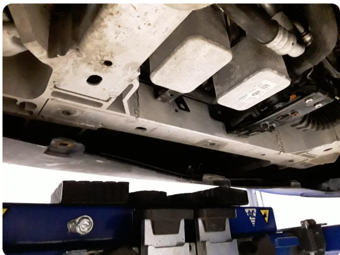
3.2 Beskyttelsesplate skadet/mangler Ikke festet ordentlig
