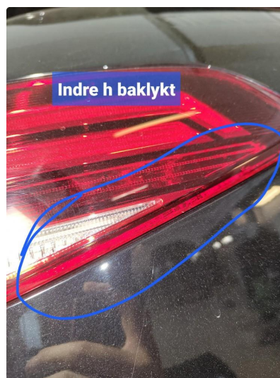
3.1 Krakelering i plast
