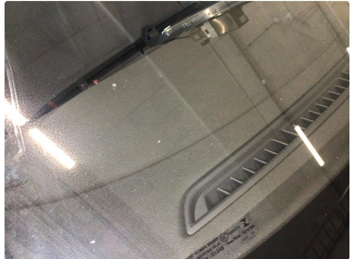
1.2 Noe steinsprut på frontvindu
