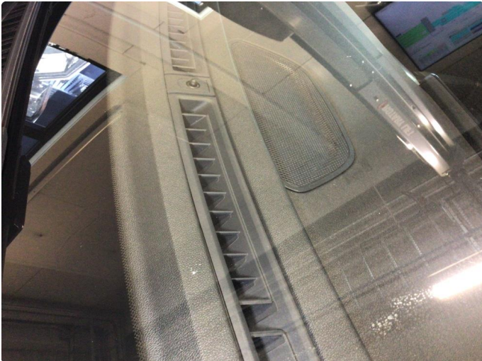
1.2 Noe steinsprut på frontvindu
