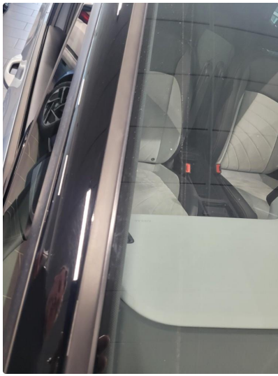
1.3 Steinsprut med sprekk utenfor synsfelt
