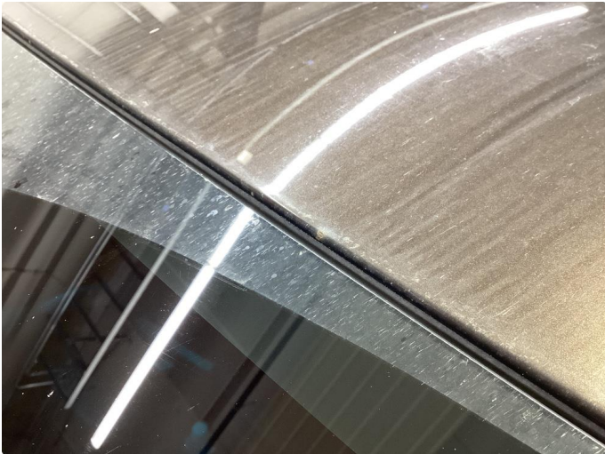
1.1 Steinsprut med rust. LAKKSTIFT BENYTTET.
