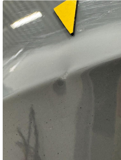
1.3 Noen bulker. Blir forsøkt med bulkfix.
