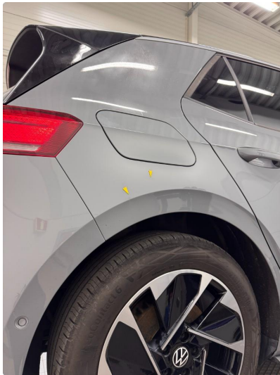
1.3 Noen bulker. Blir forsøkt med bulkfix.
