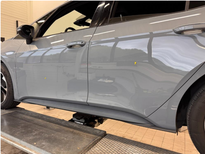
1.2 2 små steinsprut med korrosjon.
