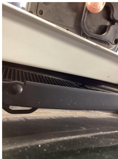
1.1 Ripe(r) ned til grunning
