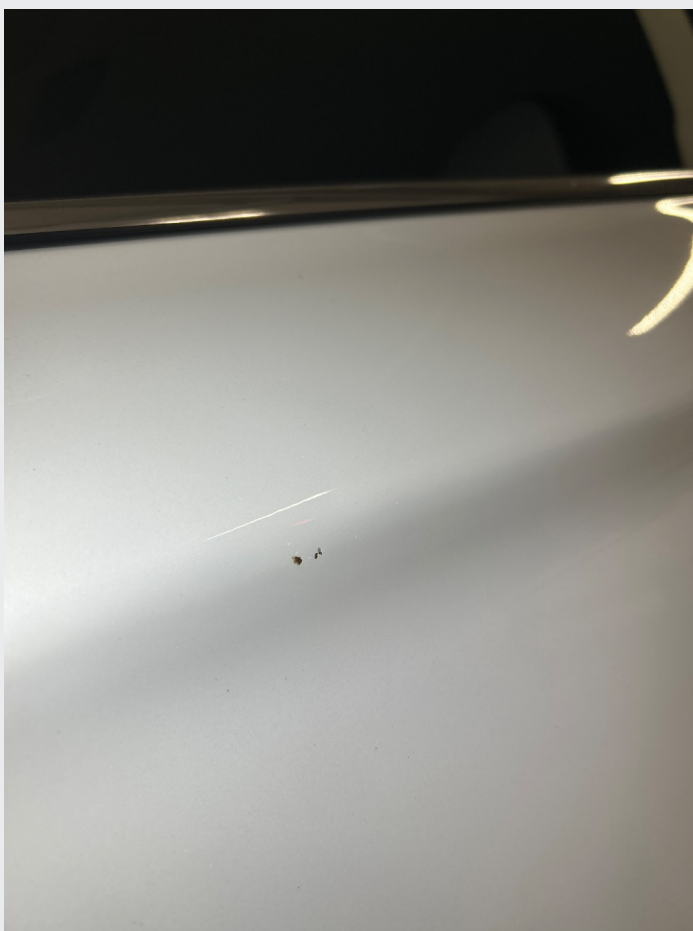
2.1 En del steinsprut og riper rundt om
