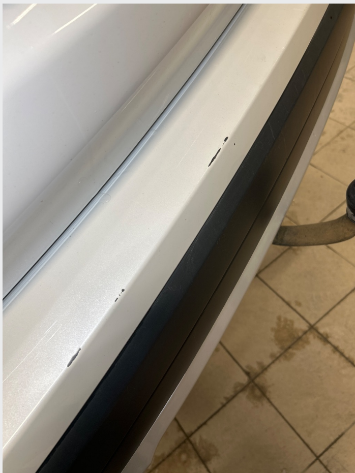
2.1 En del steinsprut og riper rundt om
