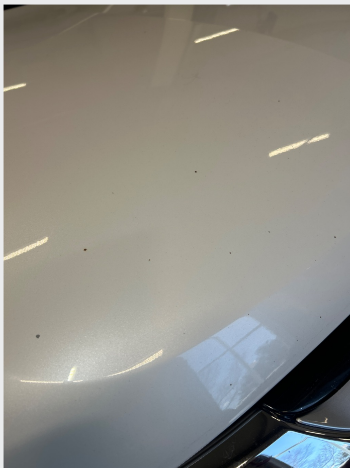
2.1 En del steinsprut og riper rundt om
