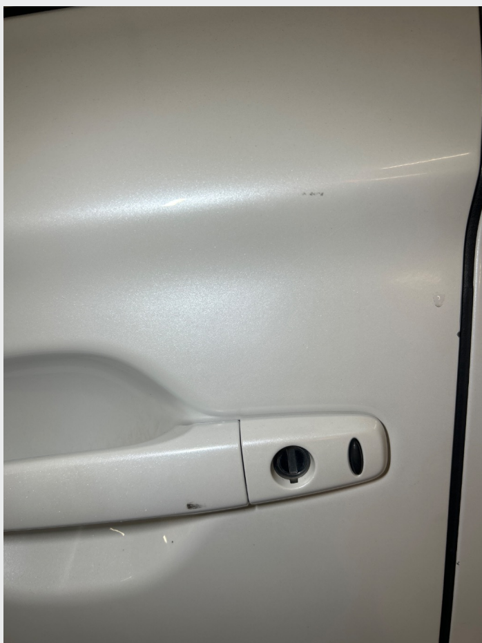
2.1 En del steinsprut og riper rundt om
