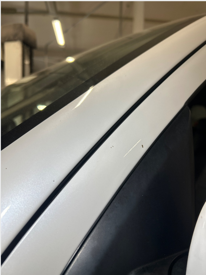
2.1 En del steinsprut og riper rundt om
