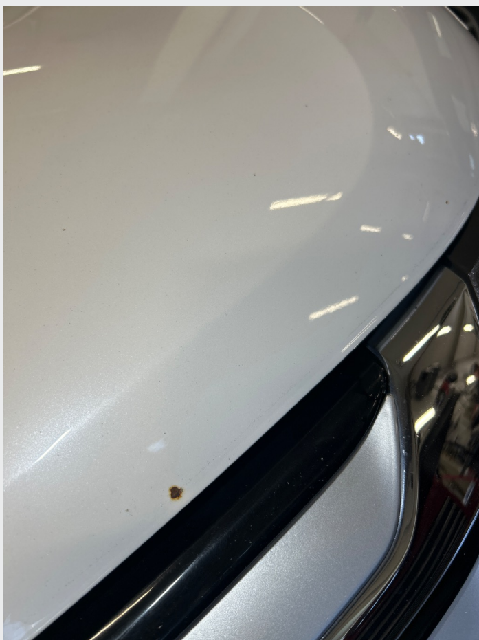
2.1 En del steinsprut og riper rundt om
