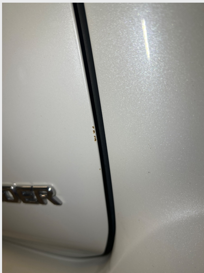
2.1 En del steinsprut og riper rundt om
