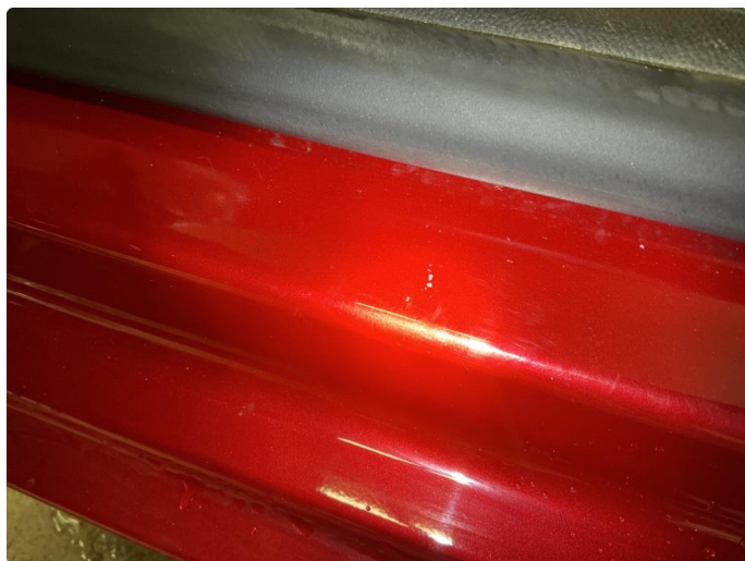
1.3 Bulk(er) med lakkskade
