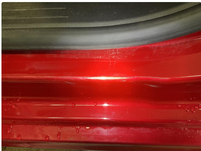
1.3 Bulk(er) med lakkskade
