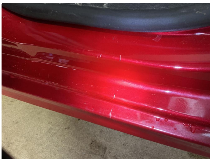
1.3 Bulk(er) med lakkskade
