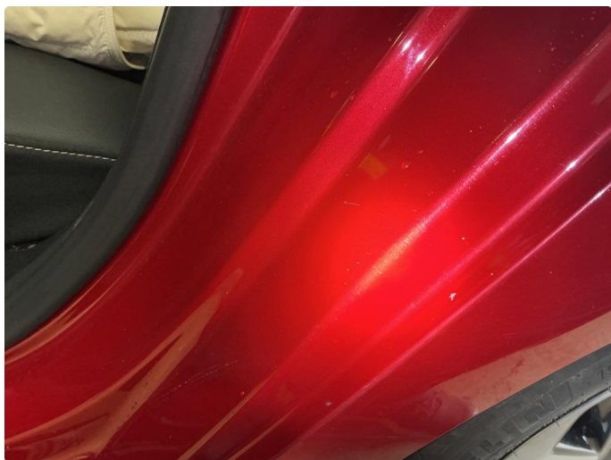
1.3 Bulk(er) med lakkskade
