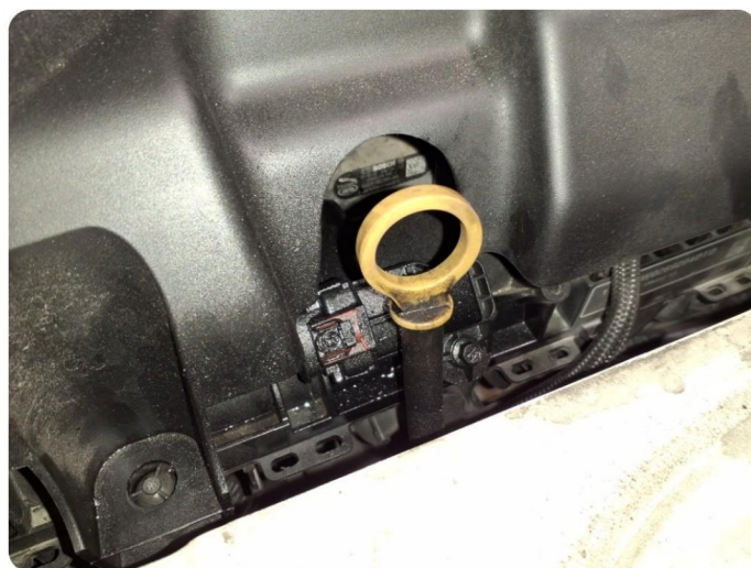
4.1 Oljelekkasje fra motor
