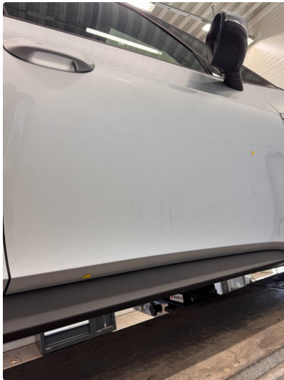
1.3 Liten steinsprut med korrosjon.
