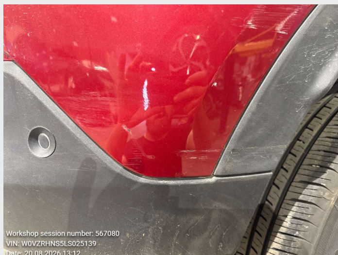
2.8 skade på bakfanger høyre side
