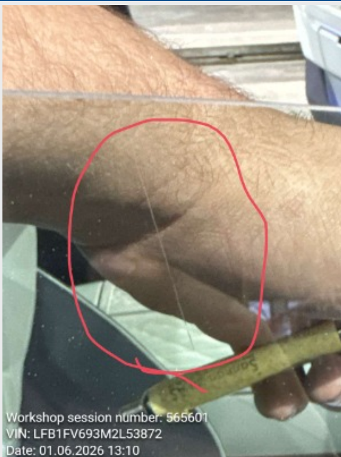
2.15 rute passasjerdør foran ripe/skade
