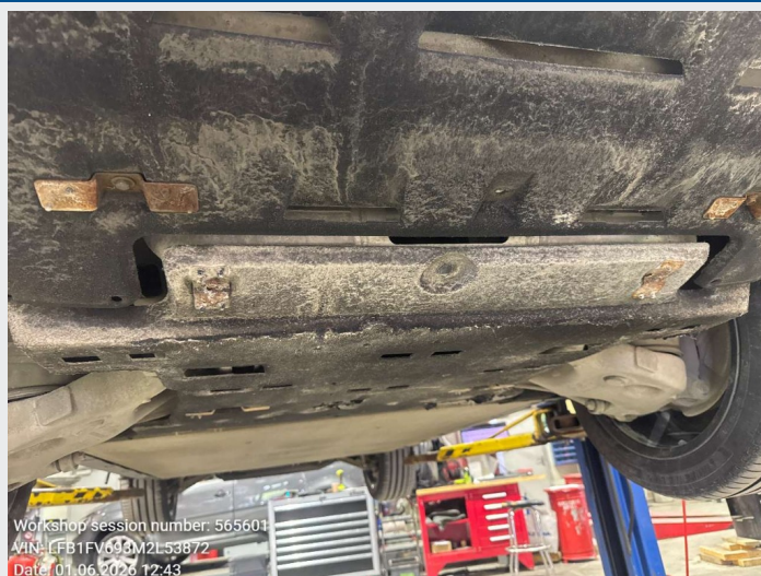
2.2 flere av plater under bil er skadet
