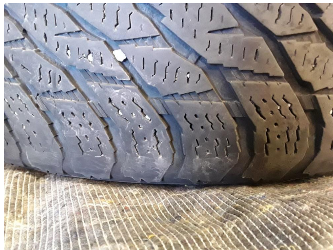
2.3 Skjev slitasje på vinterdekk
