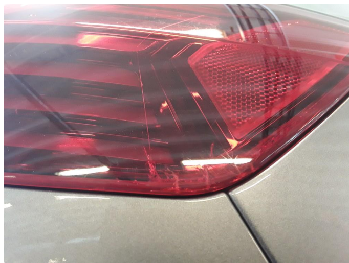
3.1 Defekt / sprukket glass
