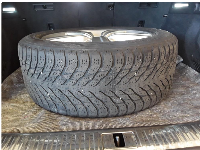
2.3 Skjev slitasje på vinterdekk
