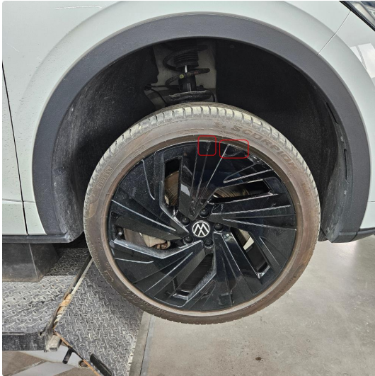
1.1 Skrubbermerke på en sommerfelg, h.side foran (blitt penslet m/lakk)
