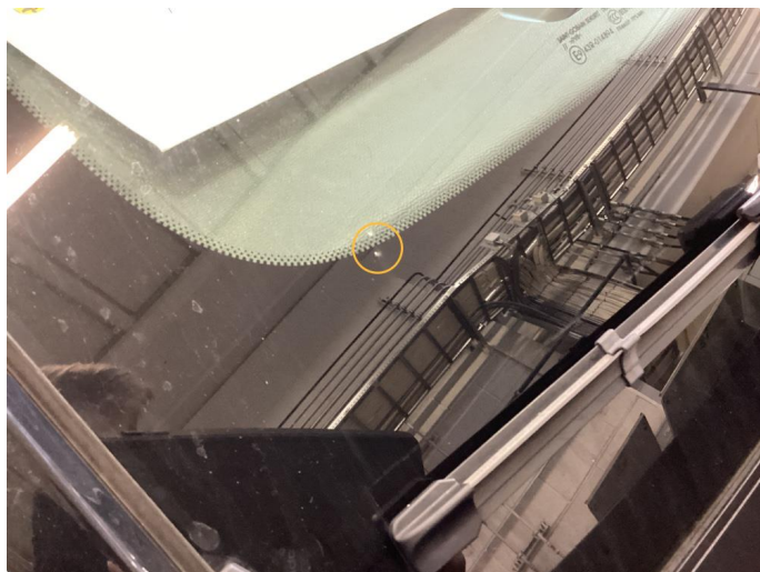
1.3 Noen små steinsprut, trenger ikke rep.
