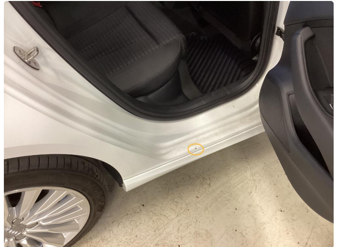
1.1 Liten bunkel med lakkskade
