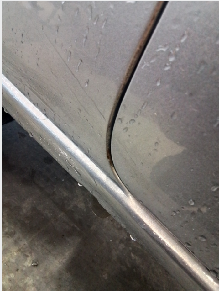
2.7 Rust nedkant skyvedør mot hjulbue høyre
