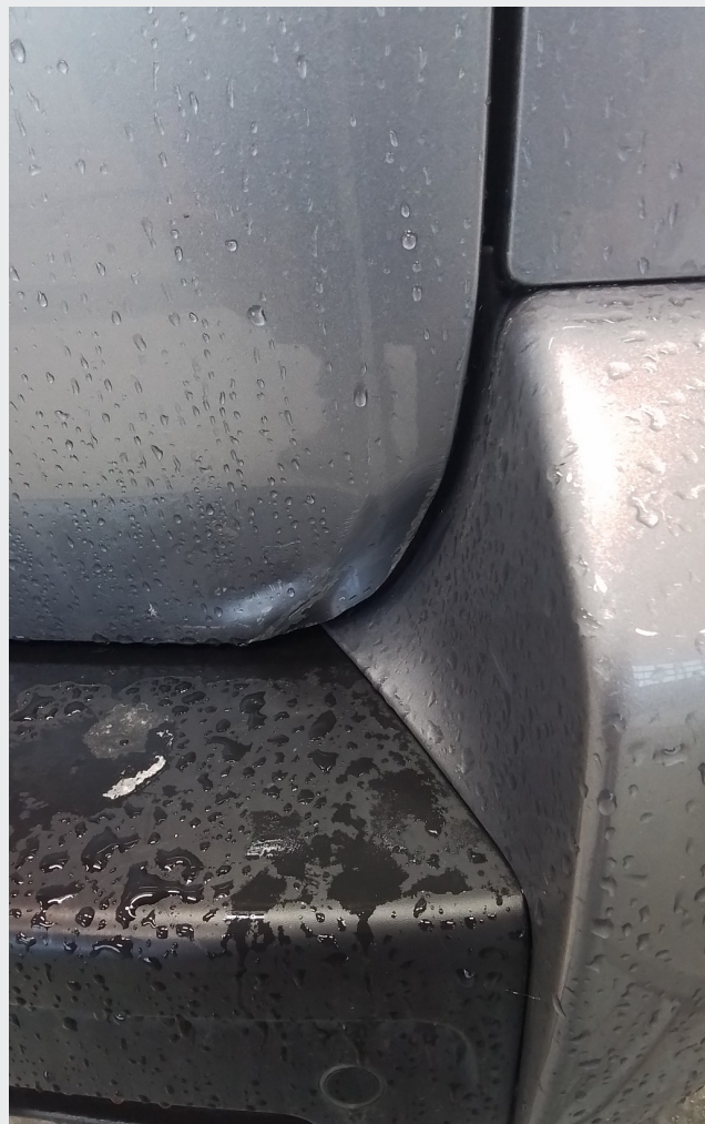
2.7 Rust nedkant skyvedør mot hjulbue høyre
