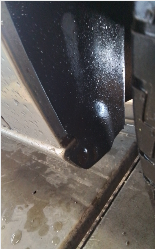
2.7 Rust nedkant skyvedør mot hjulbue høyre
