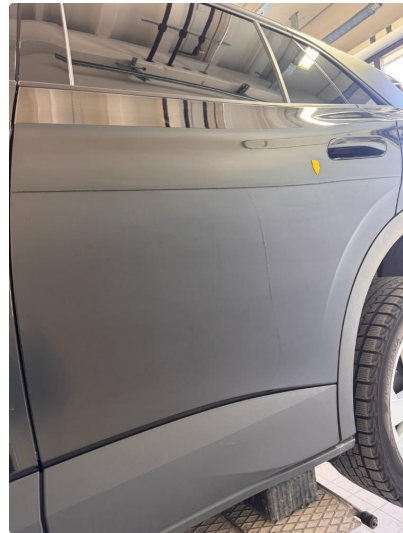
1.2 Noen små steinsprut med korrosjon høyre side.
