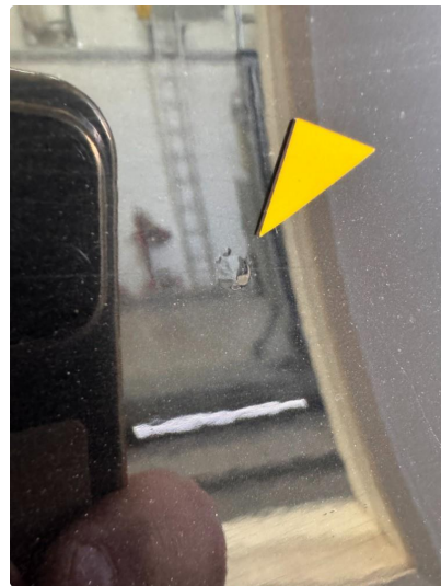
1.2 Noen små steinsprut med korrosjon høyre side.
