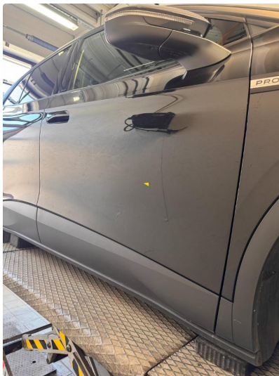
1.2 Noen små steinsprut med korrosjon høyre side.
