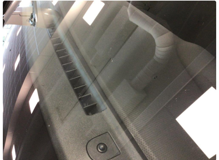
1.1 Noe steinsprut på frontvindu
