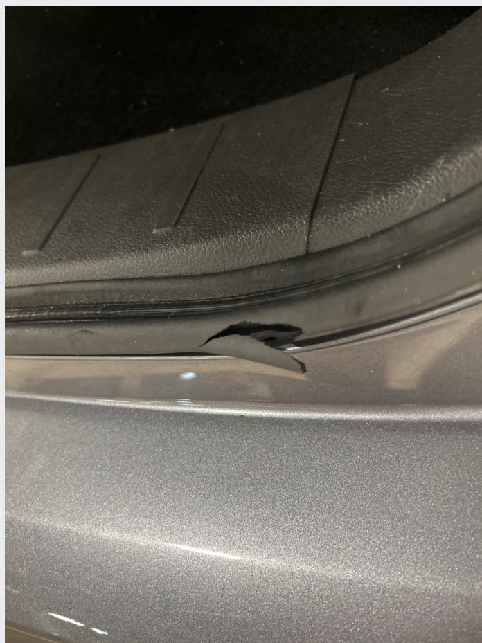
2.5 En revnet bit på pakning mot bakluke
