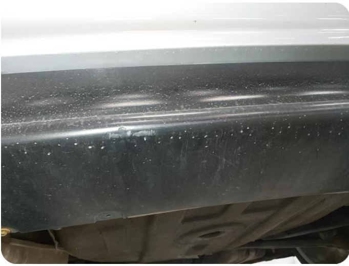
3.13 Ripe(r) ned til grunning
