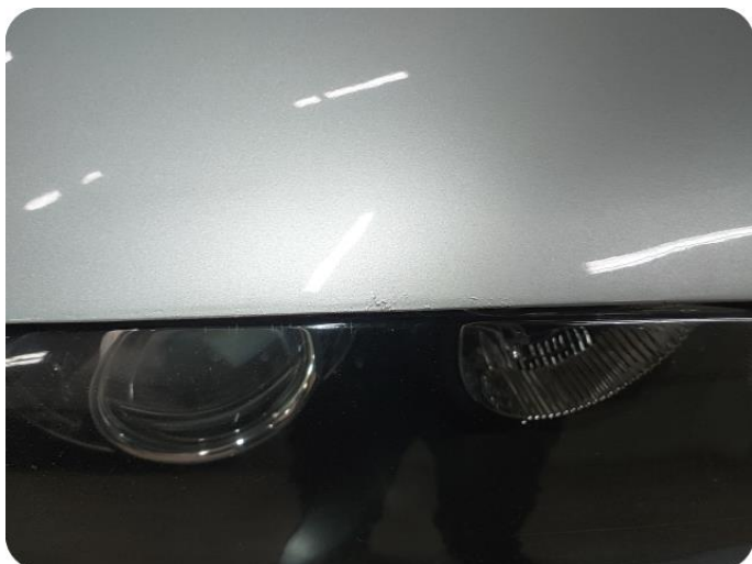
3.2 Noe steinsprut med rust
