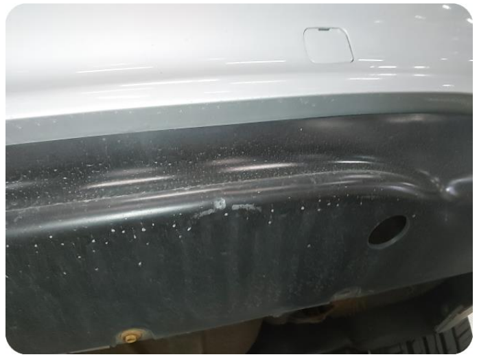
3.13 Ripe(r) ned til grunning
