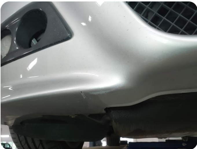
3.14 Ripe(r) ned til grunning
