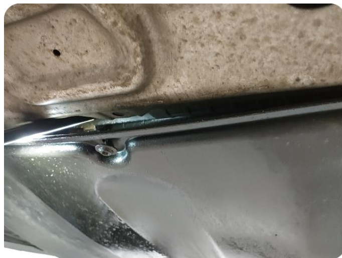
5.4 Oljelekkasje mellom motor/gear
