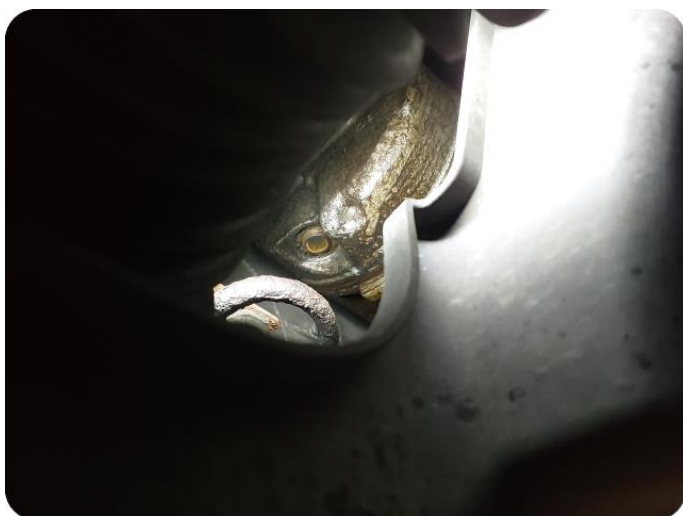
5.4 Oljelekkasje mellom motor/gear
