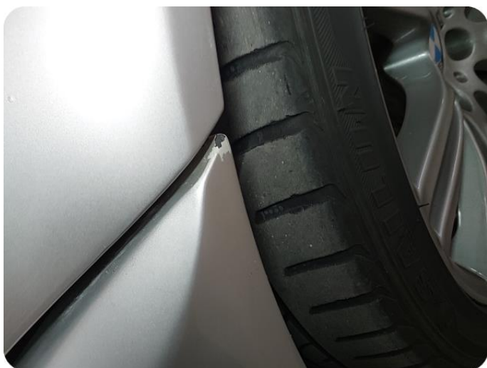
3.14 Ripe(r) ned til grunning
