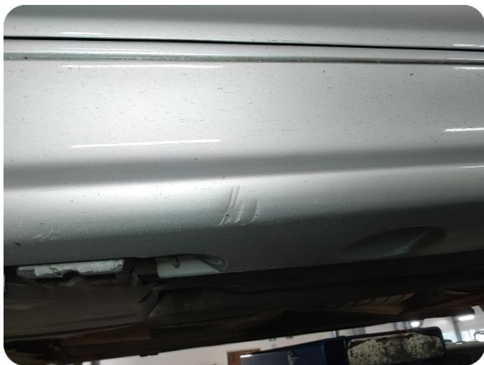
3.16 Ripe(r) ned til grunning
