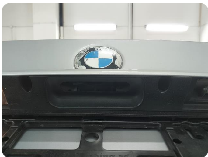
3.4 Feil på elektrisk åpne/lukkemekanisme Bakluke knappen er skadet
