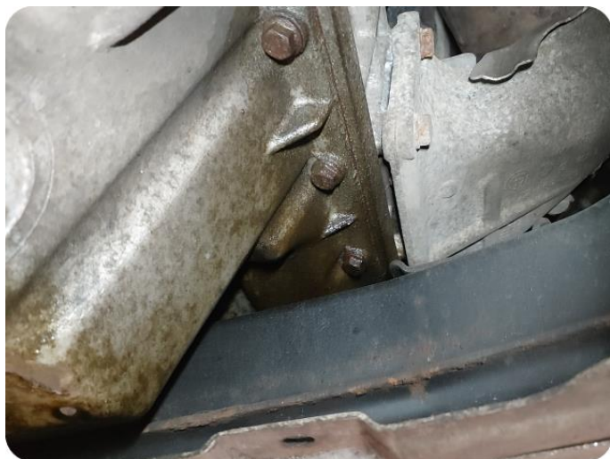
5.4 Oljelekkasje mellom motor/gear
