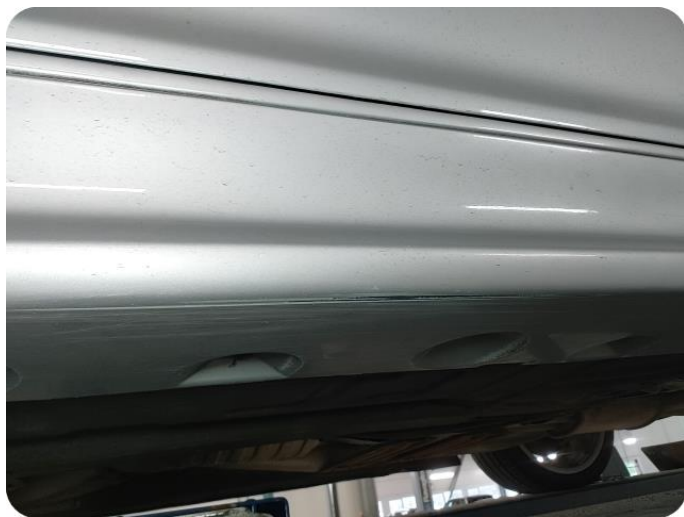
3.16 Ripe(r) ned til grunning
