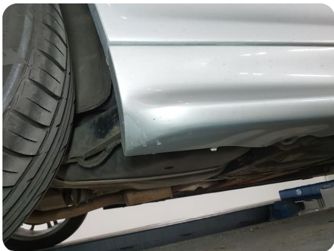
3.16 Ripe(r) ned til grunning
