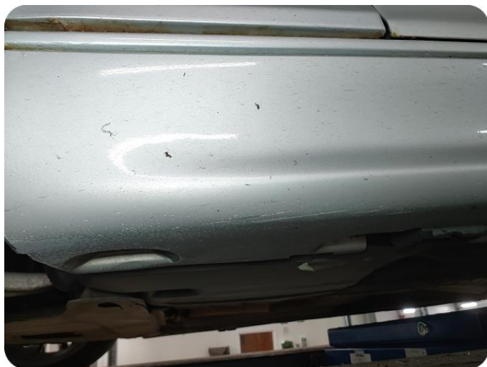
3.16 Ripe(r) ned til grunning
