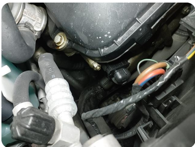
5.3 Oljelekkasje i forkant
