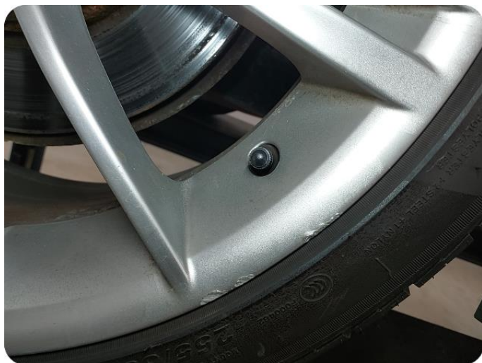
3.10 Kantkjørt felg Sommer felger
