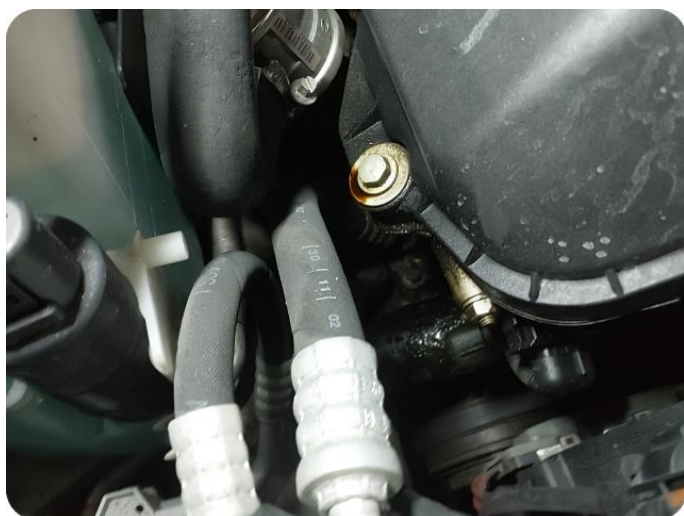
5.3 Oljelekkasje i forkant
