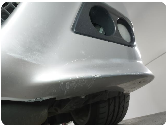
3.14 Ripe(r) ned til grunning
