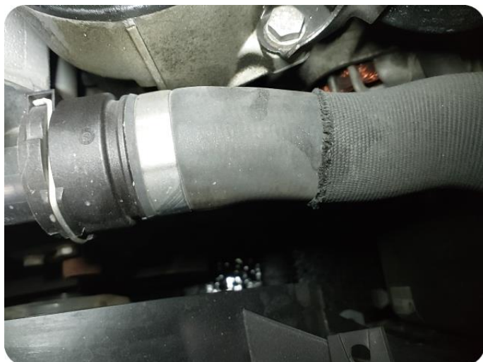
5.3 Oljelekkasje i forkant
