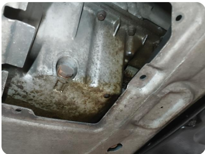
5.4 Oljelekkasje mellom motor/gear
