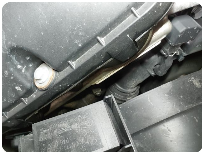
5.3 Oljelekkasje i forkant
