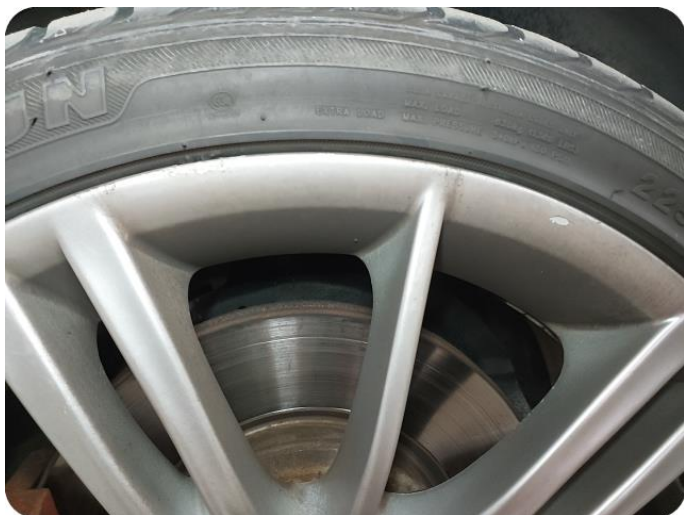
3.10 Kantkjørt felg Sommer felger
