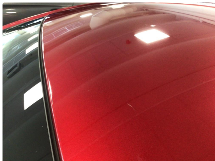
1.1 Noe steinsprut på panser, tak og front skjermer samt en liten bulk på takvange venstre side og dører høyre side, litt overfladiske riper på høyre bakskjerm
