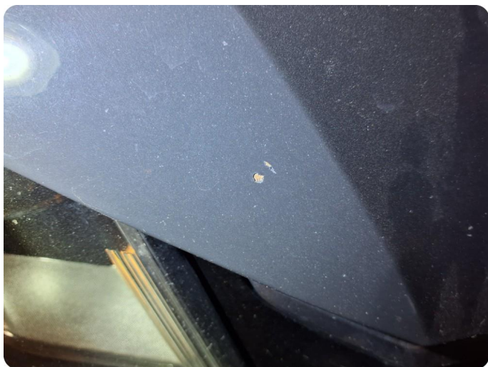
2.3 Noe steinsprut med rust
