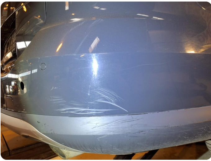
2.1 Generelt mye bruksslitasje Riper, steinsprut, oppskrapet + mye merker etter utstyr/belysning
