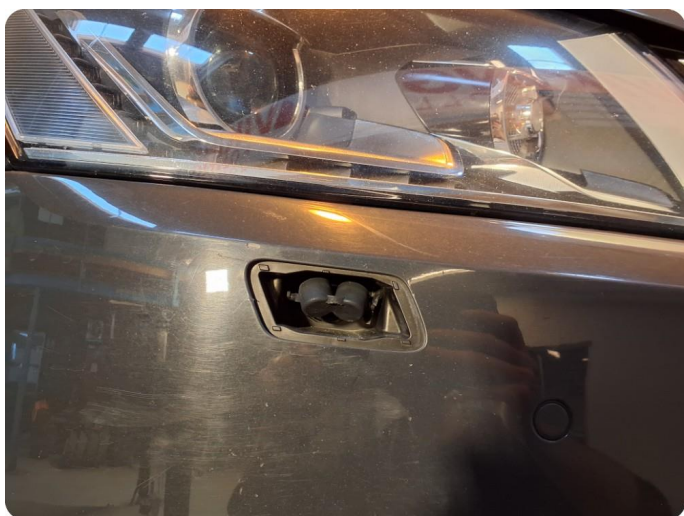
2.10 Øvrige feil Knekt/mangler lyktespylerlokk
