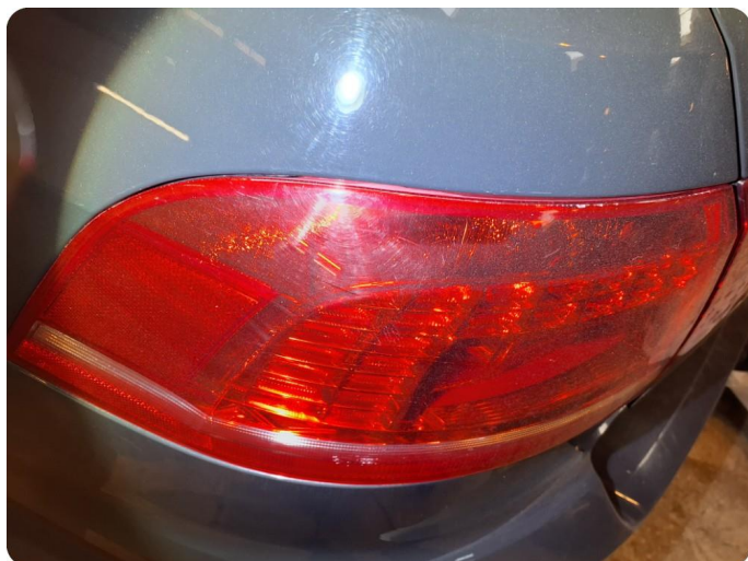
3.2 Krakelering i plast
