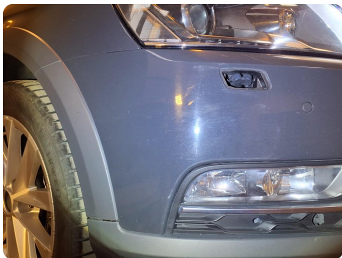
2.1 Generelt mye bruksslitasje Riper, steinsprut, oppskrapet + mye merker etter utstyr/belysning
