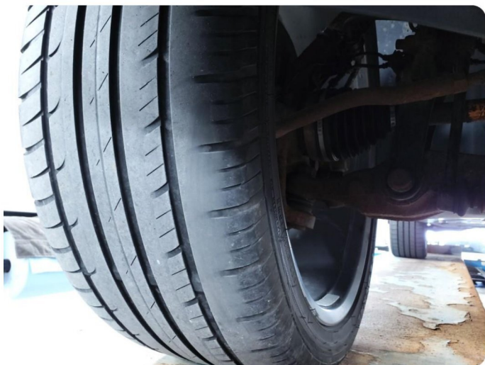
3.15 Skjev slitasje på sommerdekk
