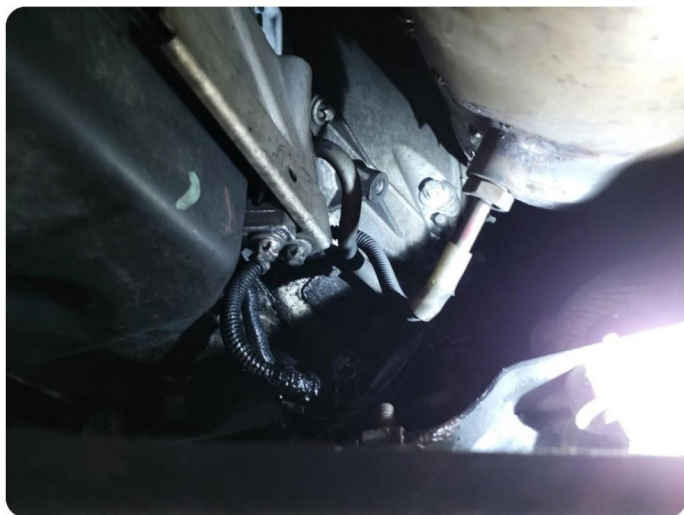
4.1 Oljelekkasje fra motor
