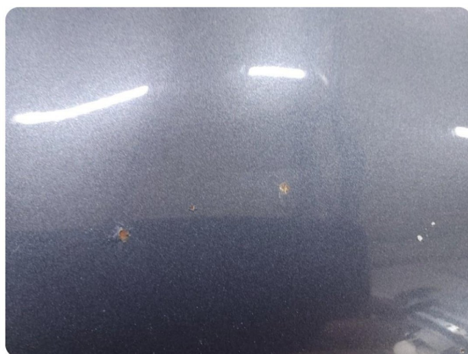
3.2 Noe steinsprut med rust
