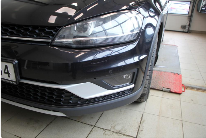
1.1 En del steinsprut i front, ellers noen små sår/riper/ små rustroser rundt om på bil. Normalt for km/alder.
