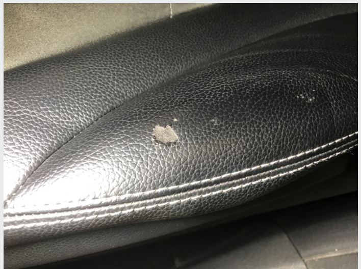
4.5 Bit av skinn på pute førersete er slitt bort.
