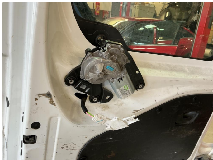
1.7 Vinduspussere virker ikke
