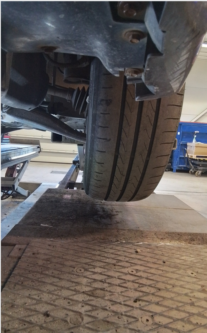
2.17 Utslitt innside sommerdekk vf
