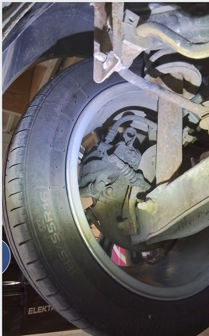
9.9 Lekkasje bremsevæske caliper vb
