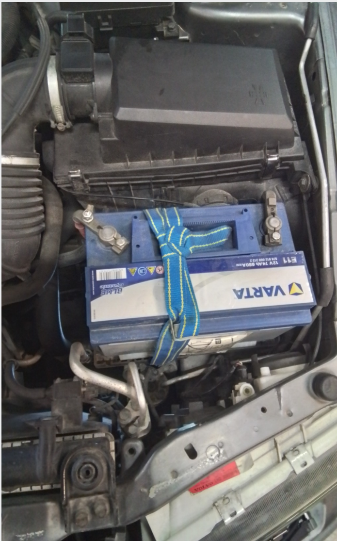
5.2 12v batteri satt fast med stropp
