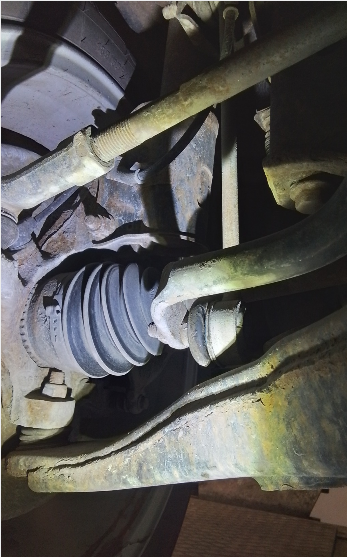
8.7 Øderlagt støvmansjett lenkearm vf
