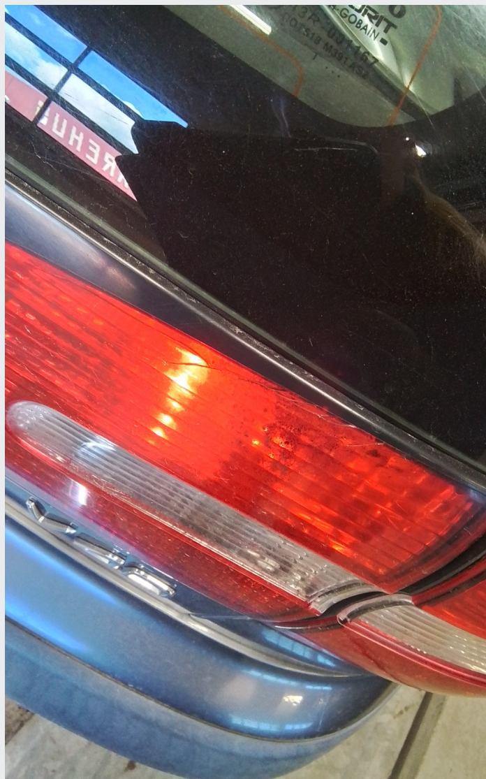
3.2 Sprekk i baklykter på bakluke
