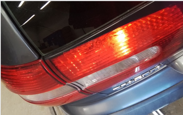
3.2 Sprekk I baklykter på bakluke
