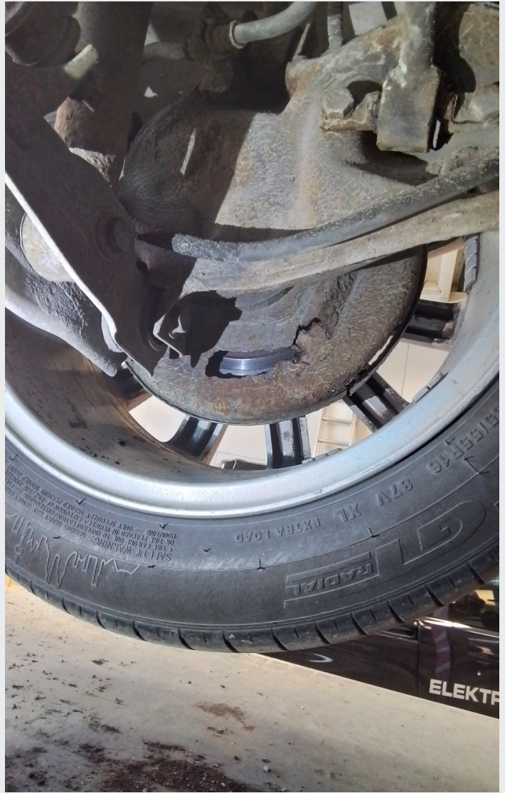
9.7 Bremseskjold bs bak opprustet
