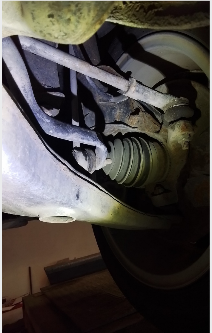
8.7 Slakke og øderlagt støvmansjett på lenkearm hf
