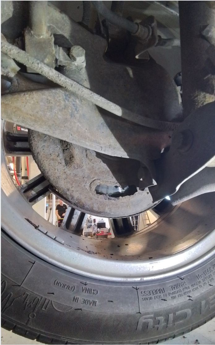
9.7 Bremseskjold bs bak opprustet
