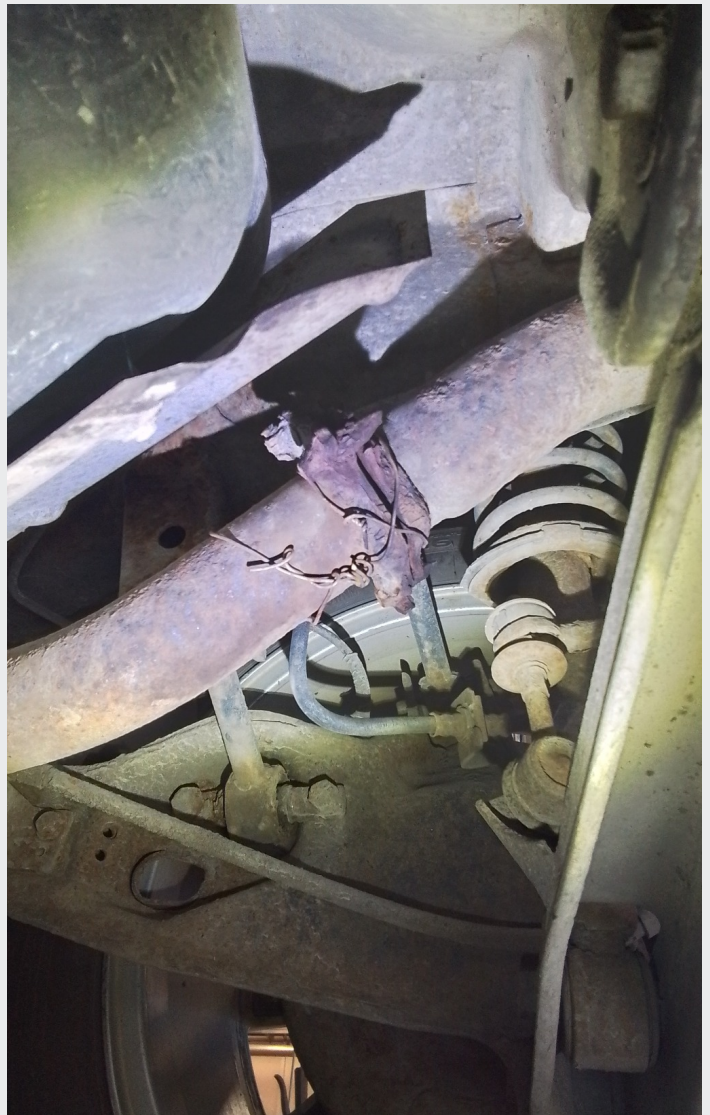
5.6 Eksoslekkasje i skjøt før bakre lyddemper
