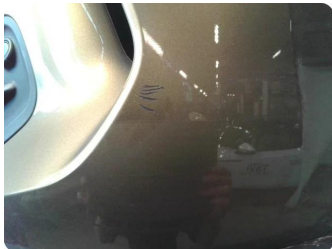
1.2 Ripe(r) ned til grunning
