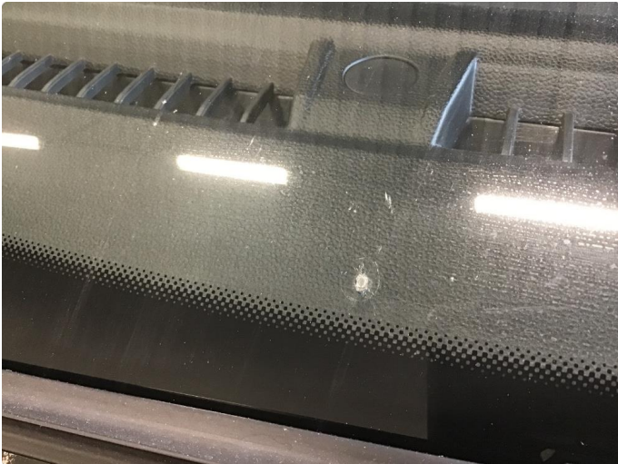
1.1 Steinsprut med sprekk utenfor synsfelt
