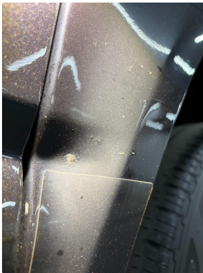
1.4 Noe lakkskader på bakskjermer
