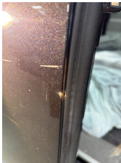
1.1 Liten bulk og korrosjon på høyre skyvedør
