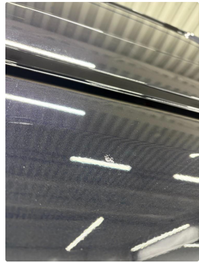
1.4 Noe lakkskader på bakskjermer
