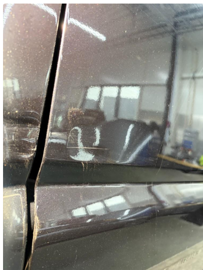
1.1 Liten bulk og korrosjon på høyre skyvedør
