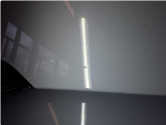
1.2 Liten steinsprut med korrosjon.
