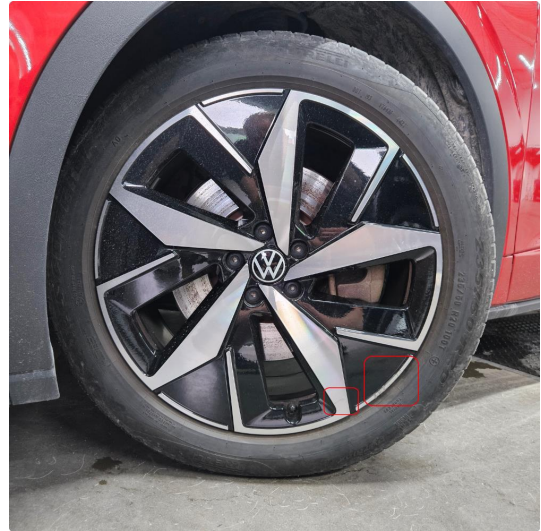
1.1 Noe skrubbermerker på en sommerfelg, v.side foran
