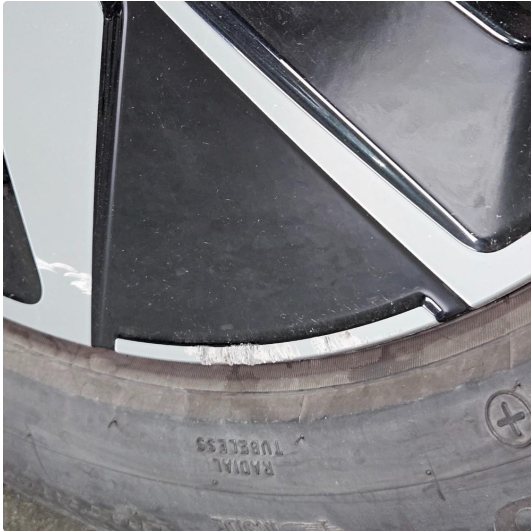
1.1 Noe skrubbermerker på en sommerfelg, v.side foran
