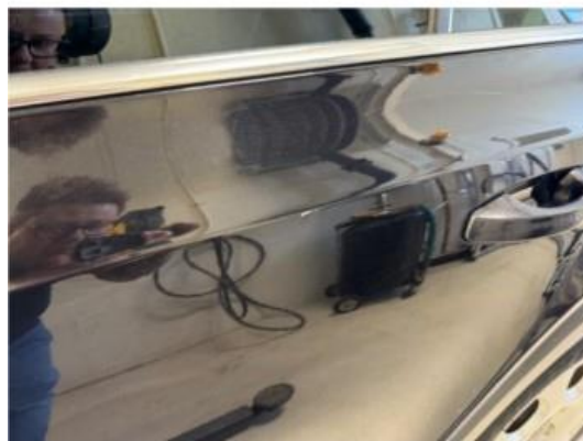
1.1 Noen bulker med lakkskader Venstre framskjerm, venstre bakdør, venstre baksjerm.
